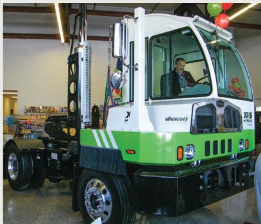
Le système Stop-Start d'Effenco permettrait notamment des économies de carburant en collecte de 15 à 36 pour cent, une réduction des heures moteur de 22 à 53 pour cent ainsi qu'une réduction des gaz à effet de serre de 15 à 37 tonnes par année, tout en doublant la durée de vie utile des freins, selon le fabricant.
